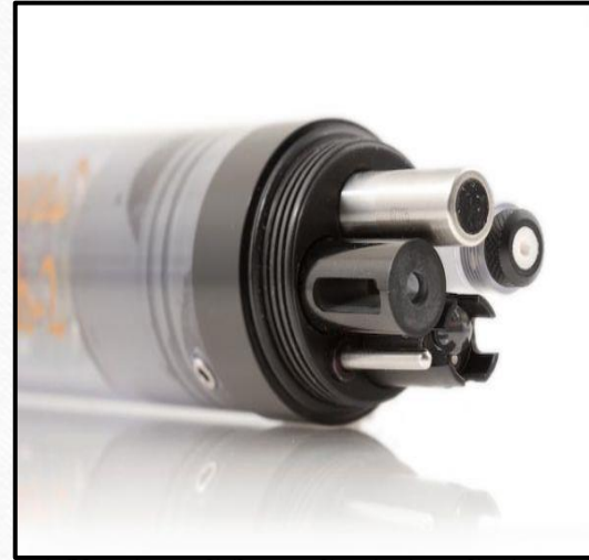
جهاز الحساسات المتعددة المستخدم لقياس العناصر الطبيعيه والكيميائيه والبيولوجيه لنوعيه المياه
